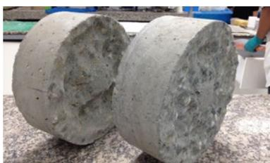
← Foto 4. Apariencia de los especímenes luego del ensayo de erosión. CORTESÍA LABORATORIO DE MATERIALES PARA INFRAESTRUCTURA CORONA®
