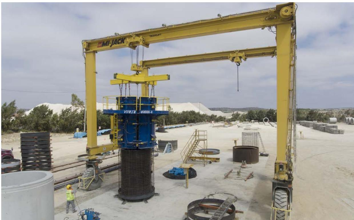
Por medio de grúa se traslada el molde interior (noyo) habilitado, es decir, limpio y con desmoldante a la parte interna de la base. A través del sistema hidráulico el noyo se “expande” y toma su posición final en la base. Luego se realizan los ajustes mecánicos requeridos por el diseño del molde garantizando la fijación y la estabilidad del mismo.
