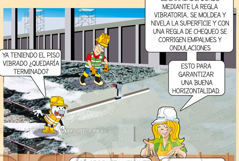
NO JOSÉ, EL TERCER PASO ES EL ENRASADO, DONDE MEDIANTE LA REGLA VIBRATORIA, SE MOLDEA Y NIVELA LA SUPERFICIE Y CON UNA REGLA DE CHEQUEO SE CORRIGEN EMPALMES Y ONDULACIONES
