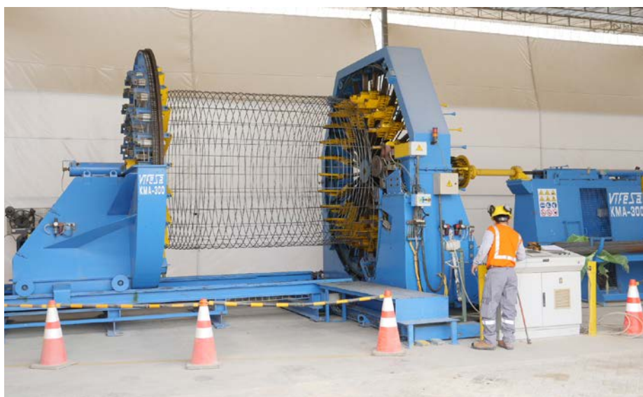
↓ Foto 5. Fabricación de armaduras.
