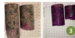
Fig. 11: Deterioro potencial en junta con fugas.
